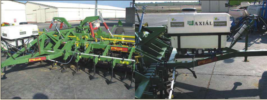
2. kép. A baktérium trágya kijuttatására felszerelt kombinátor (Phylazonit üzemavató Beszterec)
